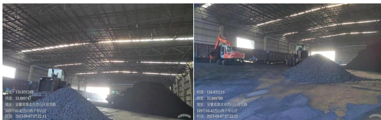
5、沪江钢构有限公司（烈山经济开发区）：企业正在生产，大部分工位未使用焊烟净化器，烟雾较浓，喷漆房敞开未密闭，喷漆件车间内晾晒，气味刺鼻。（已整改）
