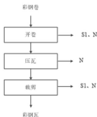
图 2-4 彩钢瓦生产工艺流程及产污环节图
